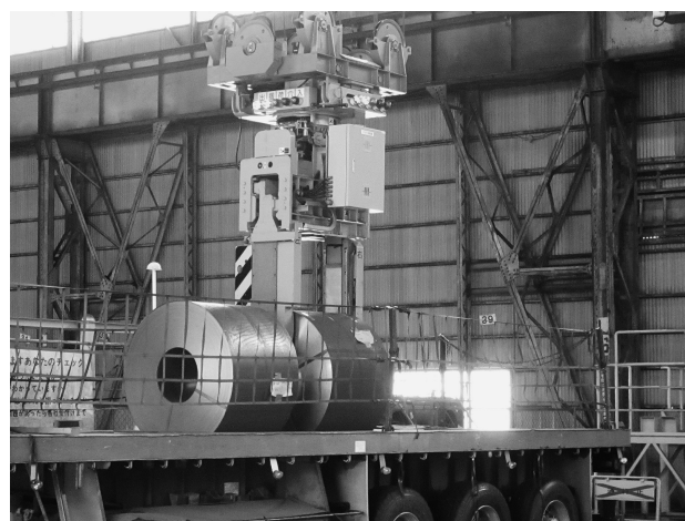
写真2 汎用セミトレーラへの積み込み作業
